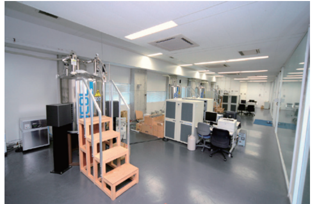
NMR測定室。手前から順に1) 固体用NMR (700 MHz)、2) 溶液用NMR (600 MHz)、3) 溶液用NMR (600 MHz)、4) 溶液用NMR (500MHz)
