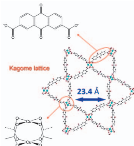
Fig. 1 2D sheet structure of [Cu(2,7-AQDC)(DMF)] ∞ .
